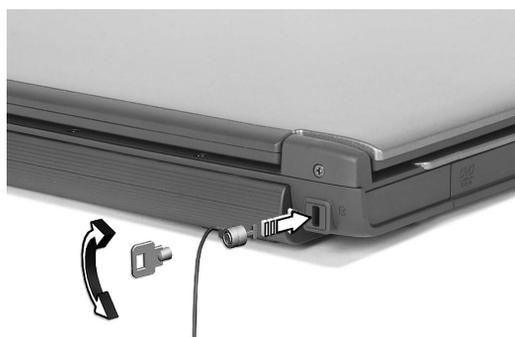
Enroulez le câble du cadenas de sécurité pour ordinateur autour d'une table, de la poignée d'un tiroir verrouillé, ou de tout autre objet fixe. Insérez le cadenas dans l'encoche et tournez la clef pour verrouiller le cadenas. Certains modèles ne possèdent pas de clef.
